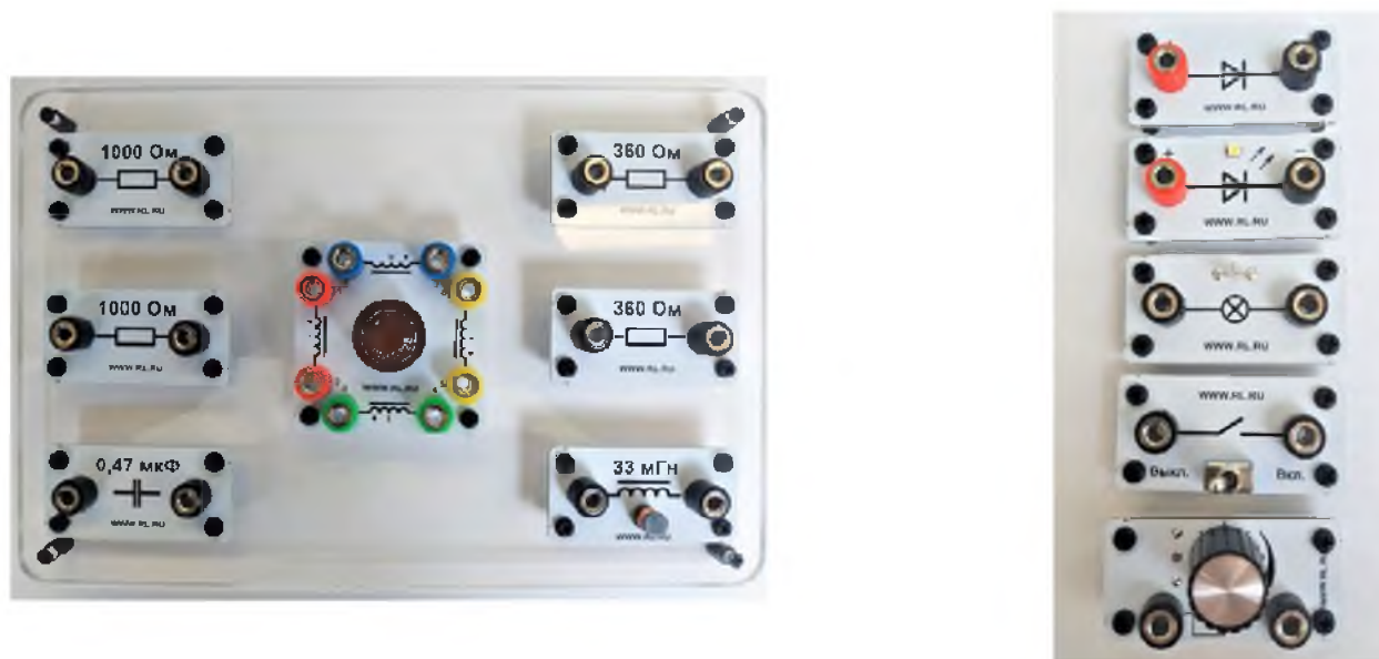
Рис. 17. Дополнительные элементы электрических цепей
