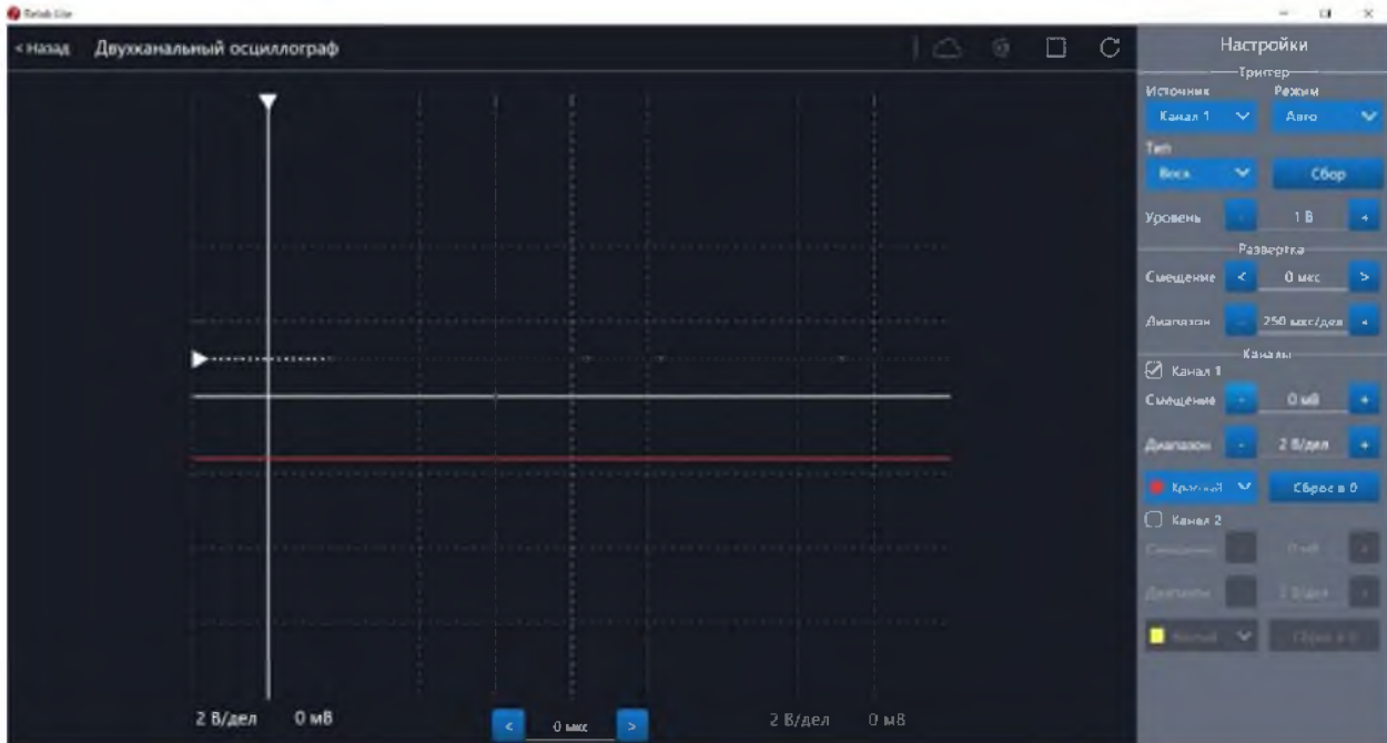
Рис. 40. Сигнал с ненулевым смещением
